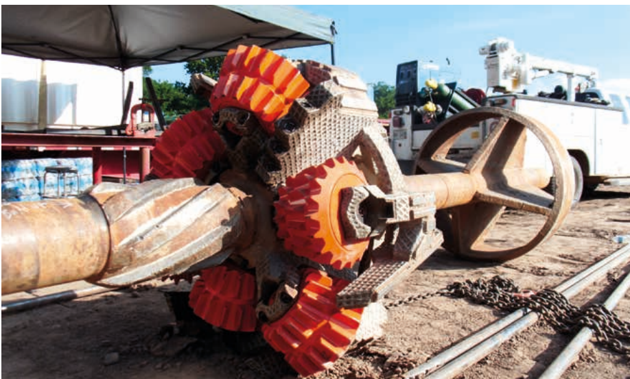
48"FFHO mit TCI-Schneidrollen und 47" Zentriereinrichtung hinten.
