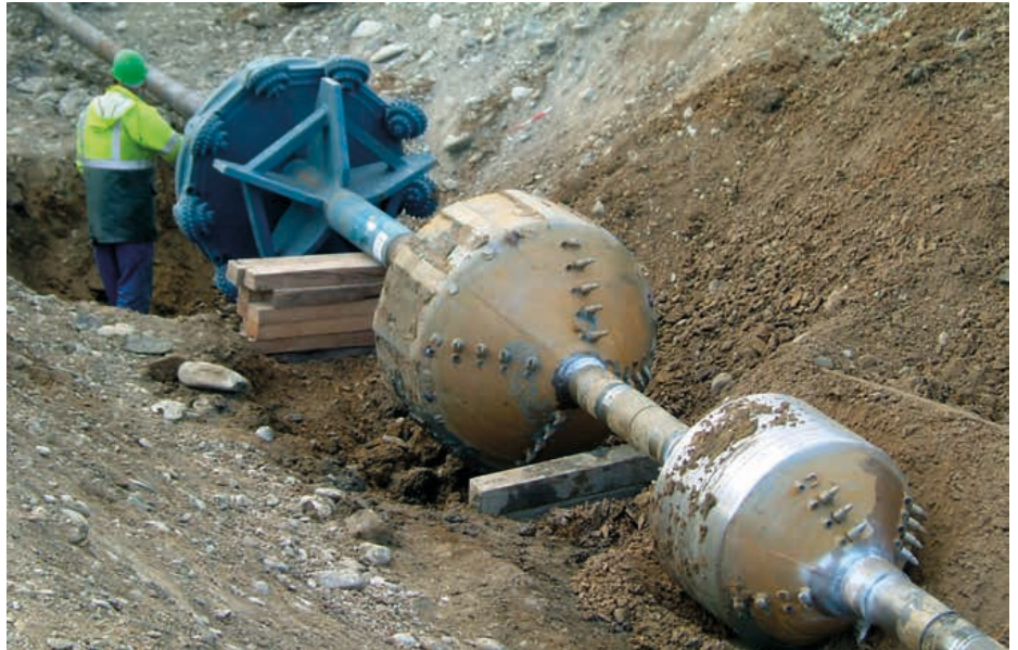
Konventioneller 64“ Hole Opener mit zweifacher vorderer Zentrierung in Form von Fassräumer (Barrel reamer)
