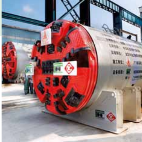
AVNB2200AE 顶管设备配备复合地层刀盘。
